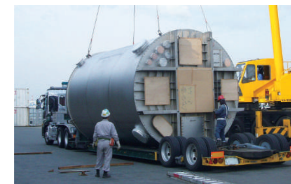
チタン製溶解槽 外径3.9M×高さ7M
