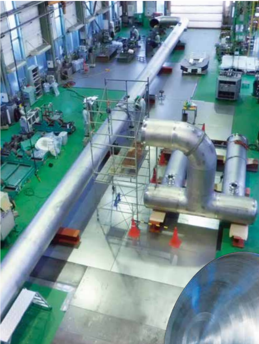
チタン製配管 外径36B×長さ37M
