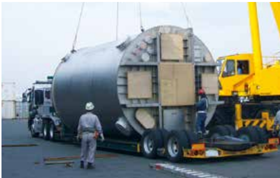
チタン製溶解槽 外径3.9M×高さ7M
